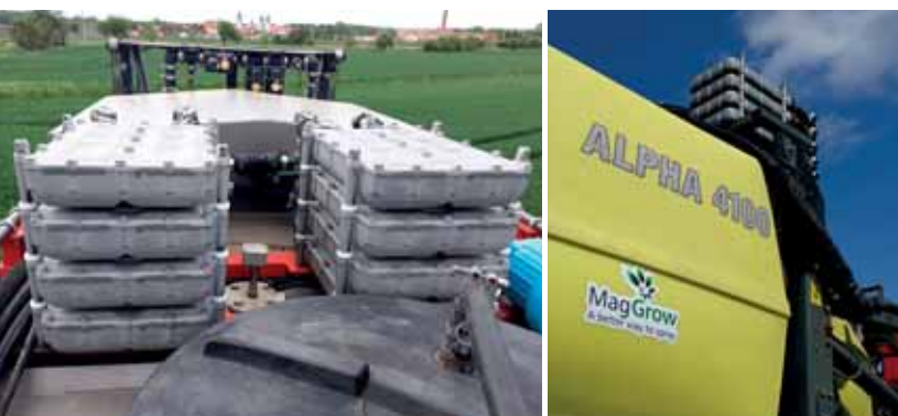
Speciální manifoldy jsou montovány na rám postřikovače
