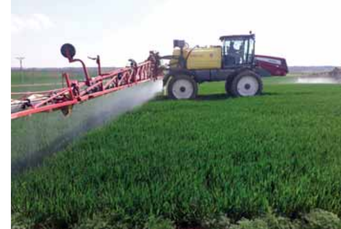
Postřiková mlha postřikovače s instalovaným MagGrow (v popředí)
